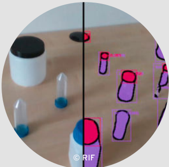
KI-gestützte Objektklassifizierung für exemplarische Laborgefäße basierend auf RGB-Bilddaten
